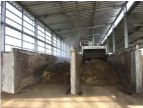
写真3 スクープ式攪拌機（1ヶ月間）
